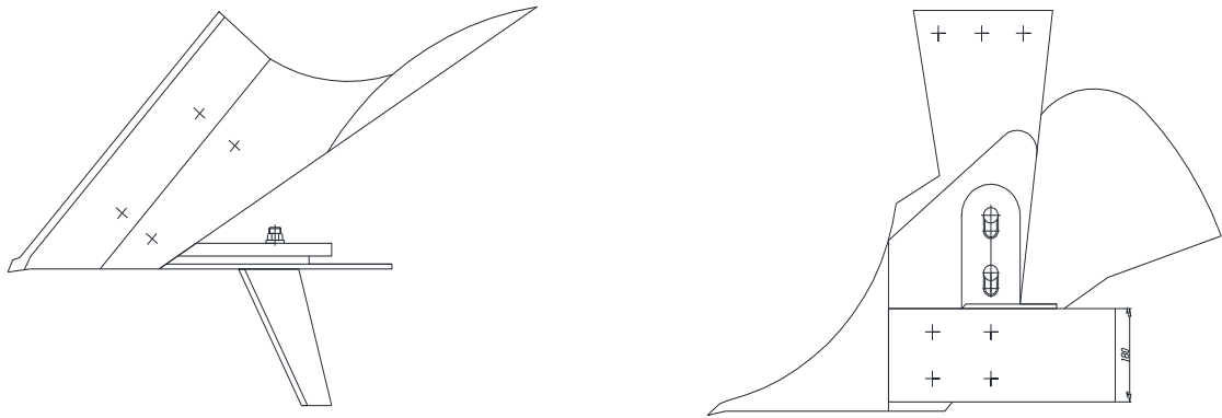
Рисунок 3.1 - Загострений елемент установлений на корпусі луга
