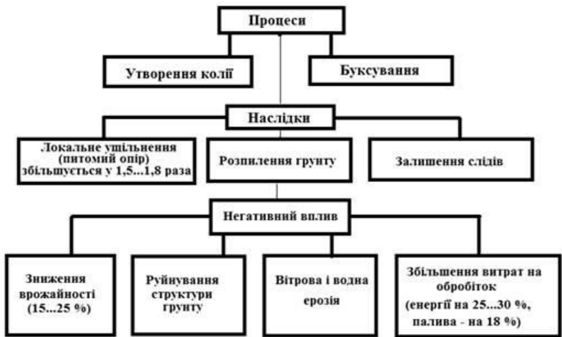
Рисунок 4.1 – Схема впливу орного агрегату глибокого обробітку ґрунту на навколишнє середовище
